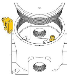
O NÃO ATERRAMENTO DO EQUIPAMENTO ACARRETARÁ NA PERDA DA GARANTIA. O condutor de aterramento deve estar interligado ao BEP (Barramento de entrada principal) da instalação de acordo com a norma ABNT NBR 5410:2004 - Item 6.4.6.
